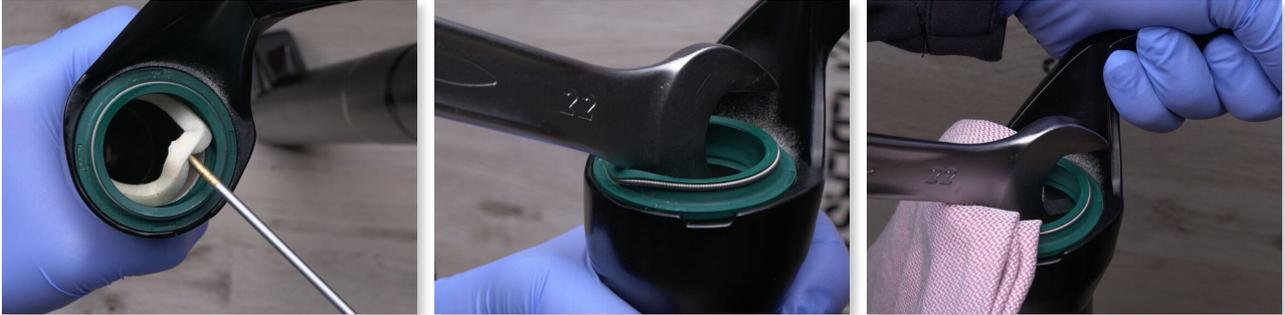
Mit einem kleinen Schraubenzieher die Schaumstoffring unter den Staubschutzabstreifen entfernen.
