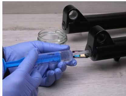
Vor dem Einführen der Standrohre in das Casting müssen die Staubschutzabstreifer gereinigt werden.
