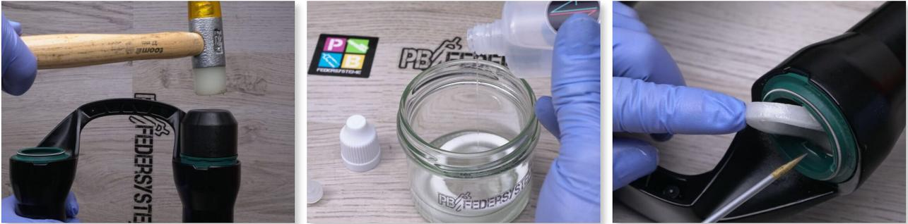
Einschlagen der Staubschutzabstreifer mit einem Schonhammer (Einschlaghilfe verwenden).
